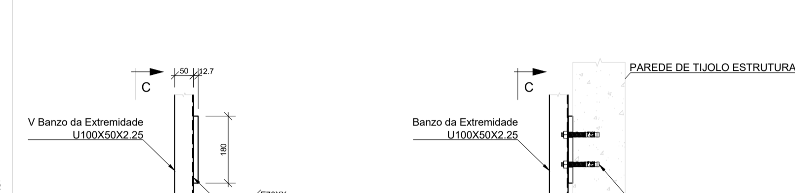
LIGAÇÃO - TESOURA E TERÇA DETALHAMENTO EM mm Esc. 1:10
